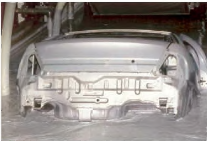
▲ Figura 18.23 Química verde para su automóvil. La carrocería de un automóvil recibe un recubrimiento de protección contra la corrosión que contiene itrio en lugar de plomo.
